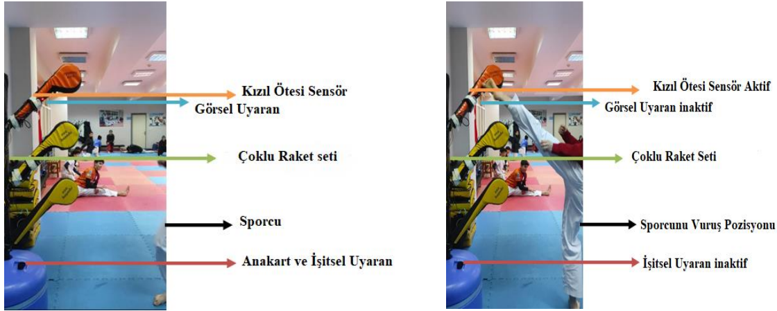
Şekil 4. Sporcuların Özel Tasarlanan Sistemle Gerçek Zamanlı Vuruş Görself
